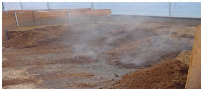
Figura 3. Vapor d'água desprendido da leira de compostagem durante a fase de maturação do composto orgânico.
