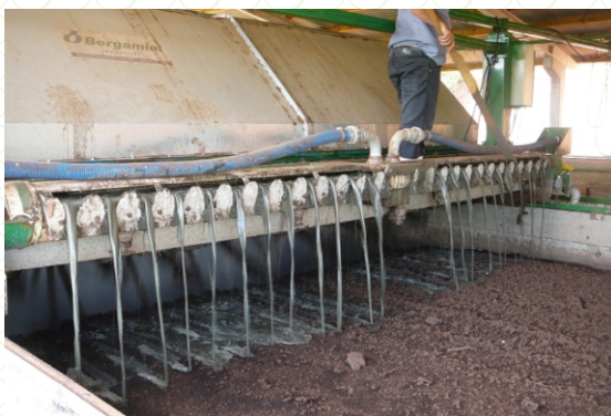
Figura 1. Equipamento aplicando dejetos de suínos em uma leira formada por serragem e maravalha.
